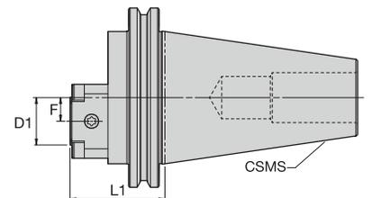
■ Устройство предварительной настройки DV хвостовик — корректирующее смещение — невращающиеся инструменты (резцы)
