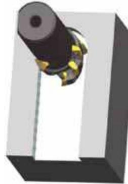
Многопроходная выборка паза с постепенным углублением по оси Z. Фреза опускается на определенную глубину и движется вдоль паза, а по завершении прохода отводится назад в исходное положение. Проходы повторяются до момента обработки паза на требуемую глубину.
