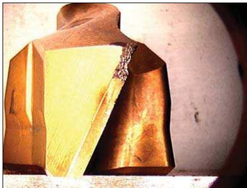
интенсивный износ по ленточке
