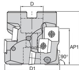
Макс. радиус закругления вершины режущей пластины составляет 0,094 дюйма для режущих элементов с диаметром в 2 дюйма и 0,125 дюйма для режущих элементов с диаметром в 2,5 дюйма и больше.
